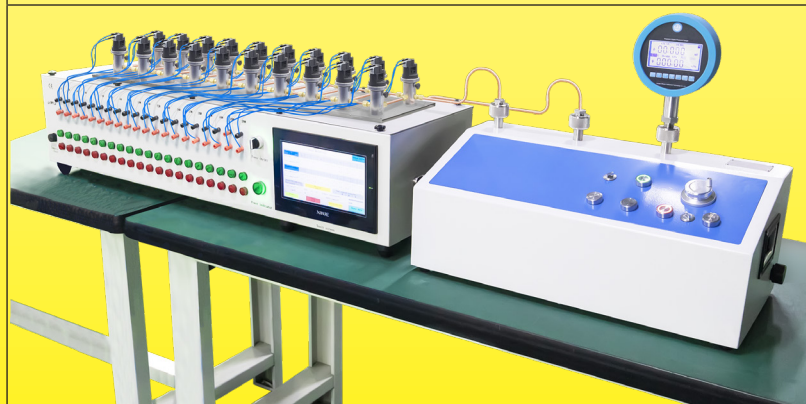
Verifica della calibrazione del pressostato
