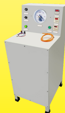
Verifica dei cicli di funzionamento dei pressostati
