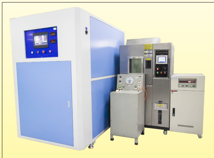
Apparecchiatura di test di durata elettrica per pressostati. (Utilizzata per la verifica della conformità agli standard UL e CE applicabili)
