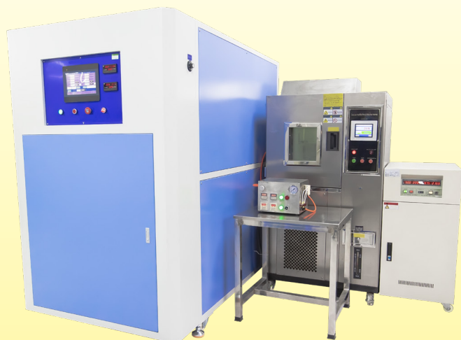
Apparecchiatura di test di durata elettrica per interruttori pneumatici. (Utilizzata per verificare la conformità agli standard UL e CE applicabili)
